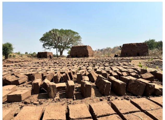
Zo worden stenen gebakken. Eerst graven, dan blokken maken en vervolgens er een toren van maken die dan als oven fungeert.
