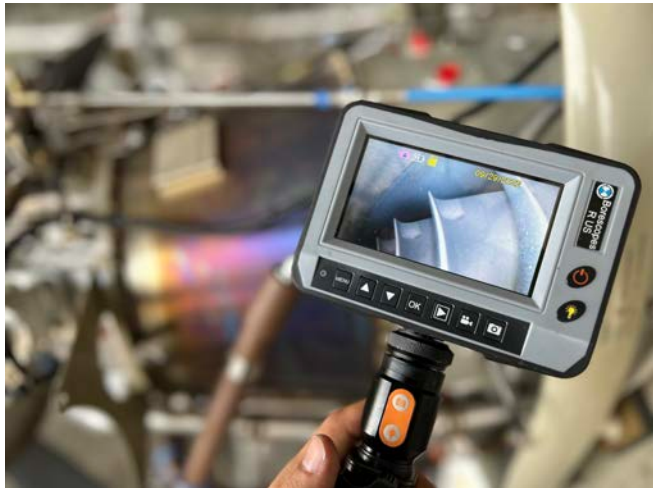
Naar de turbine bladen kijken in de motor met een boroscoop
